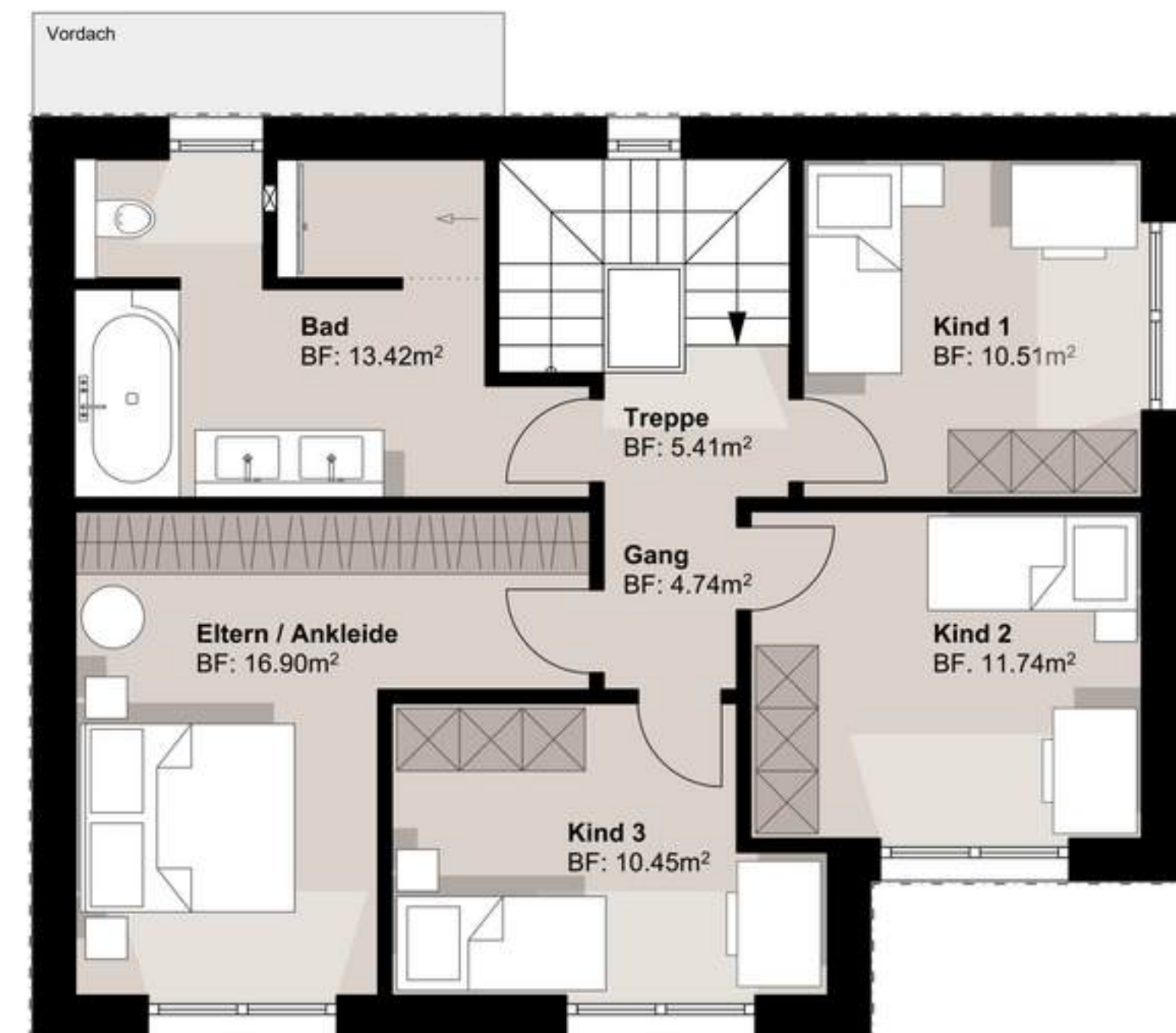
Haus Nr. 03, 08 Grundriss OG, (6.5 Zimmer EFH) Brutto-Geschossfläche = 92.30m² 1:100
