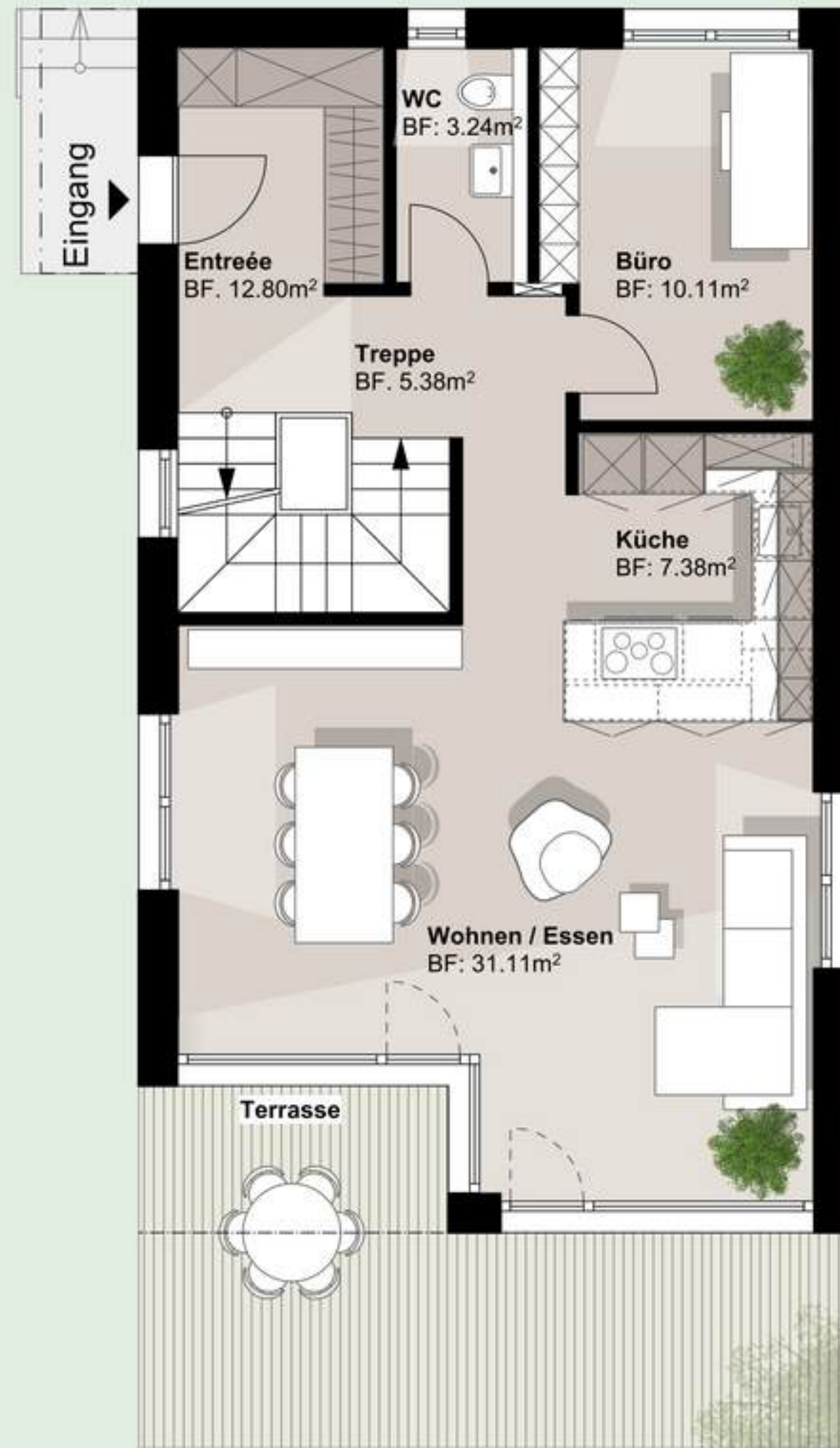
Haus Nr. 13 Grundriss EG (5.5 Zimmer EFH) Brutto-Geschossfläche = 86.50m² + Terrasse 20.81m² 1:100
