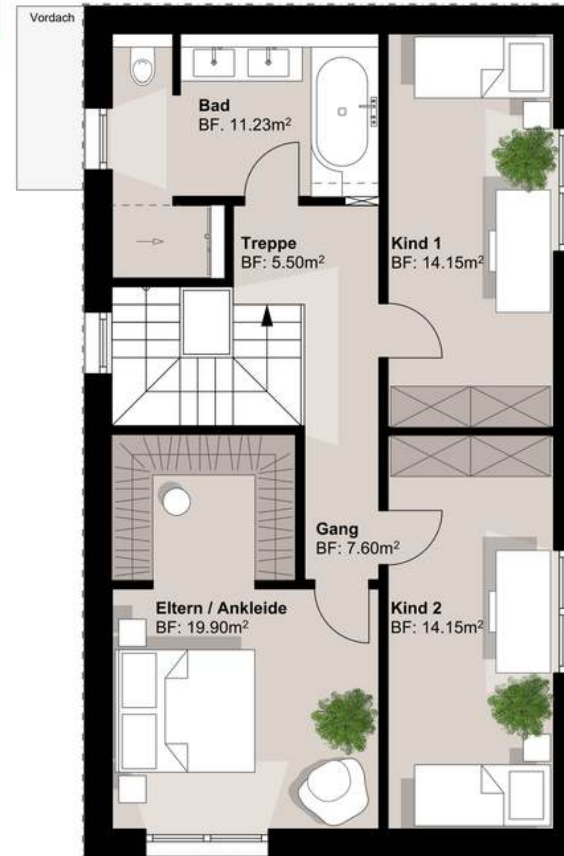
Haus Nr. 13 Grundriss OG, (5.5 Zimmer EFH) Brutto-Geschossfläche = 91.25m² 1:100
