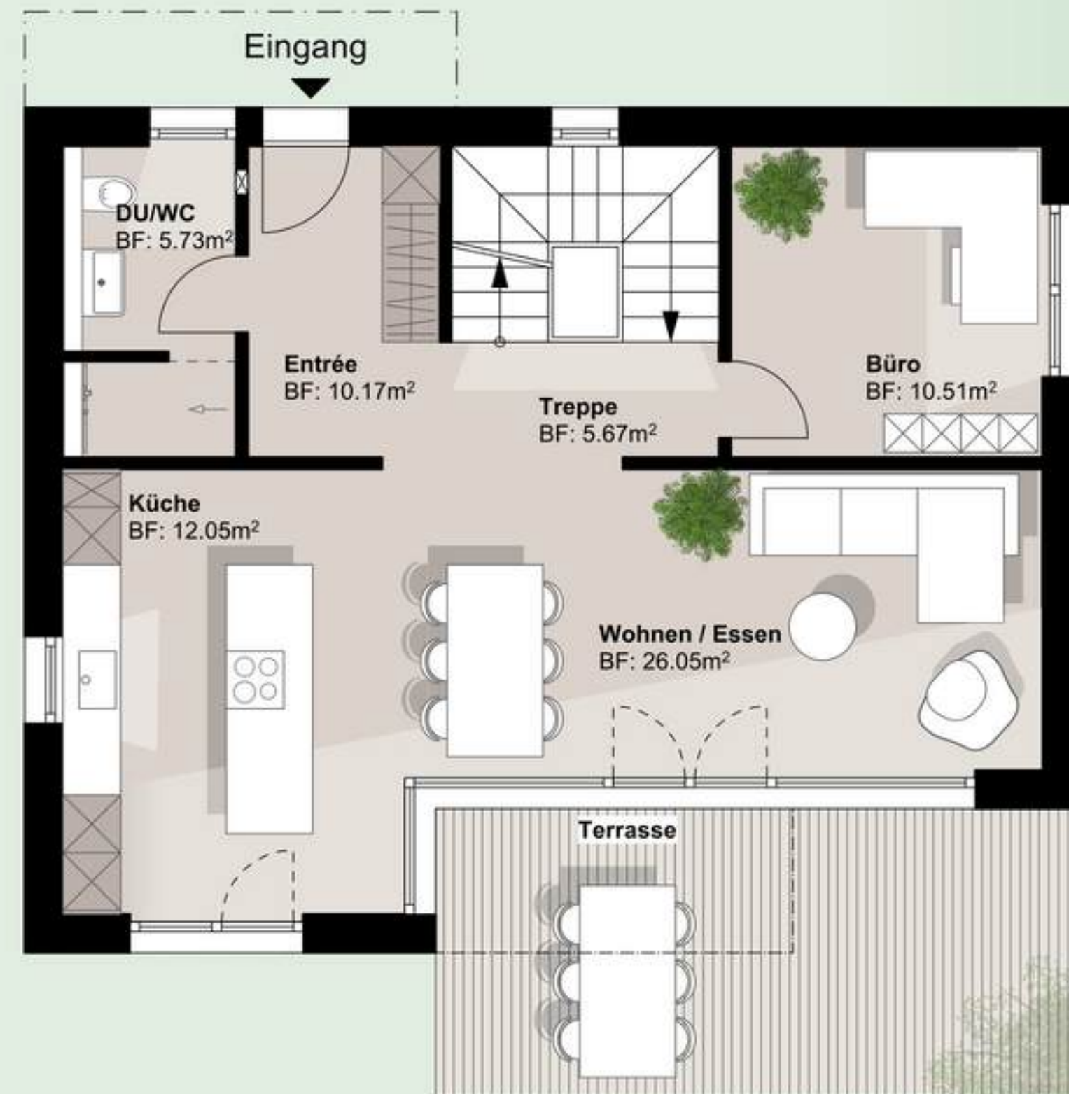
Haus Nr. 03, 08 Grundriss EG (6.5 Zimmer EFH) Brutto-Geschossfläche = 86.72m² + Terrasse 20.16m² 1:100
