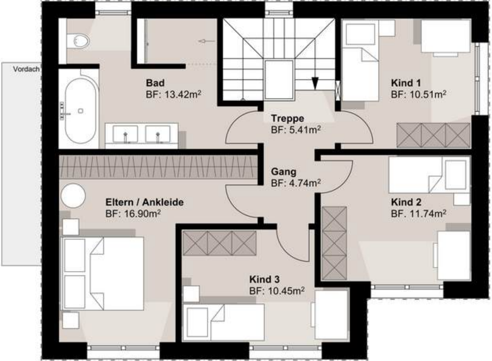
Haus Nr. 04 Grundriss OG, (6.5 Zimmer EFH) Brutto-Geschossfläche = 92.30m² 1:100
